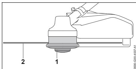
Pokud jsou žací struny kratší než 25 mm, nemohou být automaticky doseřízeny.
